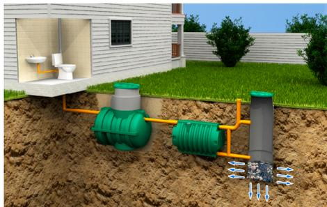
Сброс очищенной воды самотеком в придорожные канавы, при использовании в зимнее время года, может привести к намерзанию льда в отводящем трубопроводе и блокированию выхода чистой воды. Для использования АК «Rostok» в зимнее время года рекомендуется установить накопительного колодца и дренажного насоса для принудительного отведения очищенных стоков.
